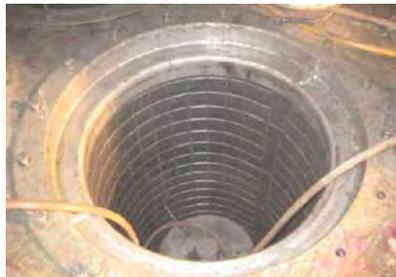
**A C14 Carbon Fibre, Hanging Candle Filter Xtra-Flow Style**
